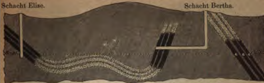
Profil durch den Elisenschacht und den Berthaschacht.
